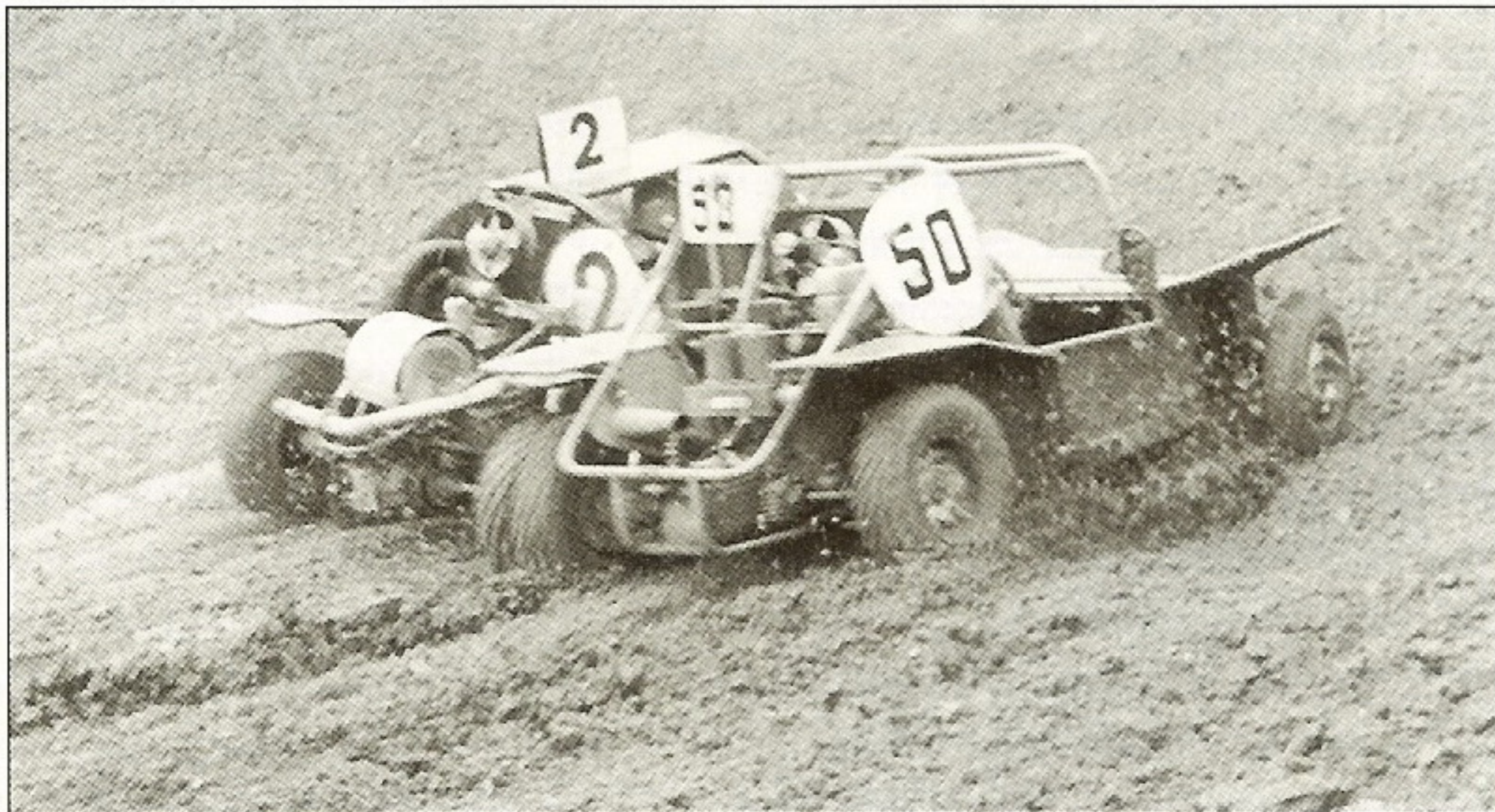
A 75–80 lóerőt teljesítő, Melkus-vezérlésű négyhengeres Wartburg (50-es rajtszám)
